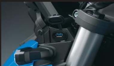
USB-Steckdose 39100-25810-000 Eine Steckdose zum Aufladen elektronischer Geräte über einen USB-Anschluss. Es gibt eine Abdeckung, um die Steckdose vor Staub, Sand usw. zu schützen. Es handelt sich um einen USB Typ-A mit einem Ausgang von 5V/2A.
