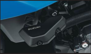
Sturz-Pad 41900-25810-000 Hilft bei der Reduzierung von Schäden und verleiht dem Fahrzeug ein attraktives Aussehen. Er ist mit dem SUZUKI-Logo versehen. Satz für die rechte und linke Seite.
