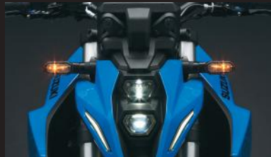
Clignotant à LED 35600-48810-000 Clignotants à LED high tech. Jeu de deux clignotants avant et deux clignotants arrière. Relais et matériel de fixation inclus.
