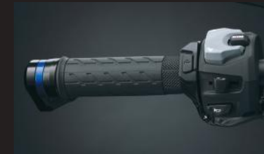
Poignée chauffante 57100-25810-000 Ce chauffage de poignée dispose de 3 niveaux de chaleur réglables. Il permet de garder toute la surface de la poignée chaude pour une conduite agréable.
