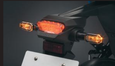
Clignotant à LED 35600-48810-000 Clignotants à LED high tech. Jeu de deux clignotants avant et deux clignotants arrière. Relais et matériel de fixation inclus.
